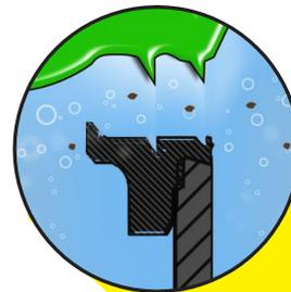
Die Doppeldichtungs-konstruktion umfasst zusätzlich zur Hauptmembrandichtung eine Doppelmesserkante am Einlass.
