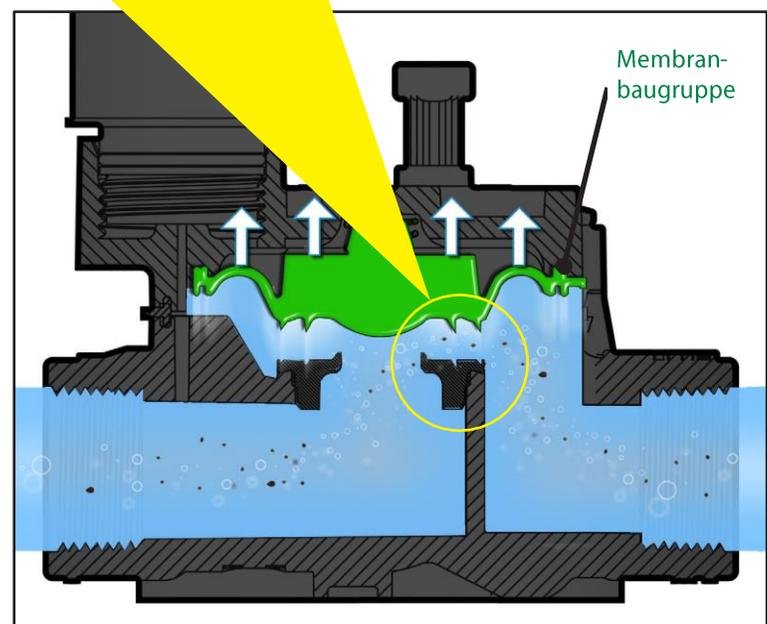
Die speziell konzipierte Lippe hebt die Membran bei Betrieb mit niedrigem Durchfluss höher, sodass sich kleine Partikel nicht unter der Dichtung verfangen, was andernfalls zu Aussickern und nicht schließenden Ventilen führen kann.
